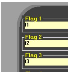
Con i sensori 1,2 e 3 comandiamo i flag F1, F2 ed F3 in modalità tipo campanello, ovvero saranno attivi solo nel tempo di pressione del pulsante che, ricordiamo, simula l'assorbimento del carico.
